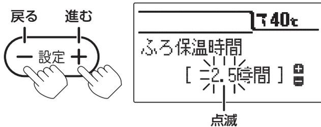
設定スイッチでご希望の時間に設定します。設定時間は0～10時間までは30分単位、10時間以上は1時間単位で変わります。最大24時間まで設定できます。
