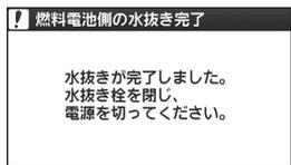
**1** 燃料電池ユニットの水抜き栓(2か所)ア → 閉める
