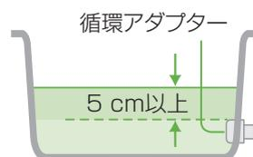
**1** 循環アダプターのバブル切替レバーを「bubble」(右)側にする
