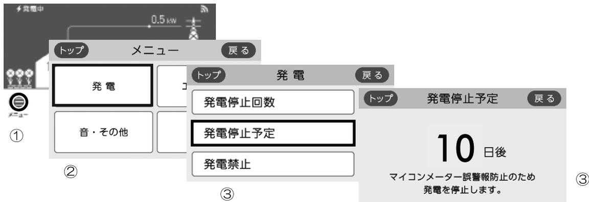
(2) 上記(1)の確認で、予想される停電開始日が該当する場合は、リモコン操作にて「発電禁止」操作(59ページ参照)で発電ユニットを停止させてください。発電ユニット停止には約3～5時間必要で、リモコンの⚡が消灯したら停止完了です。その後、連続で24時間以上停止させ、その間に全てのガス機器(給湯・暖房など)を連続で70分以上停止させてください。
