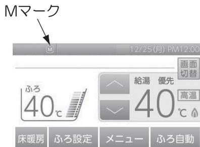
ガスマイコンメーターの安全機能確認のため、発電ユニットは約26日ごとに24時間停止します。（停止後は自動で運転を再開しますので、操作は必要ありません。）
