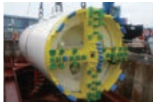
シールドマシン(木更津シールド工事)※
